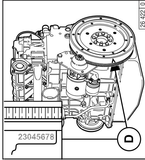
Die Motornummer **D** ist auf dem Kurbelgehäuse sowie auf dem Firmenschild eingestempelt.
