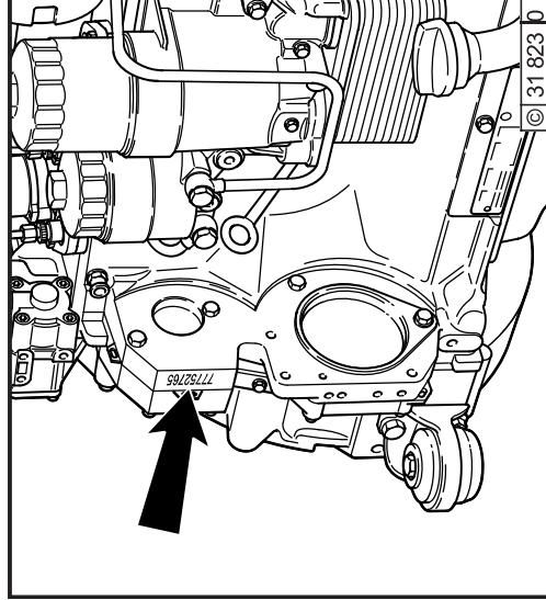
Die Motornummer ist auf dem Kurbelgehäuse (**Pfeil**) sowie auf dem Firmenschild eingestempelt.
